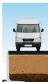
DLF10GSZ gelijkmatig verdeelde overlast 25 kN/m 2
