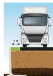
DLF10GS gelijkmatig verdeelde overlast 40 kN/m 2 op randafstand 1 m equivalent aan belastingsmodel LM1 volgens NBN EN 1991-2
