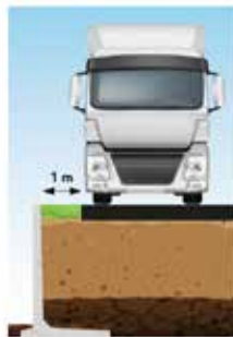
DLF10GSZ gelijkmatig verdeelde overlast 40 kN/m 2 op randafstand 1 m equivalent aan belastingsmodel LM1 volgens NBN EN 1991-2
