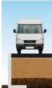
DLF10GS gelijkmatig verdeelde overlast 25 kN/m 2
