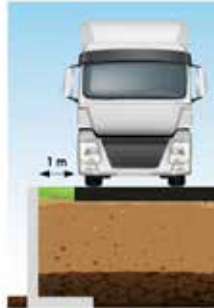
DLF10GS gelijkmatig verdeelde overlast 40 kN/m 2 op randafstand 1 m equivalent aan belastingsmode LM1 volgens NBN EN 1991-2
